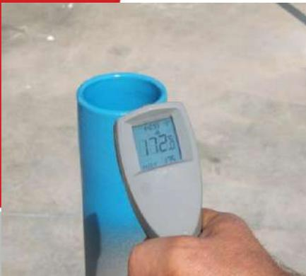
Medidor de temperatura infravermelho com ponteiro laser que permite verificar remotamente a temperatura dos produtos mesmo durante o procedimento de revestimento
