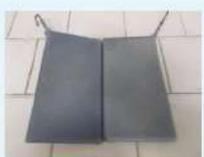
Fotografia delle lastre dopo l'immersione nel liquido di prova "acetone".
