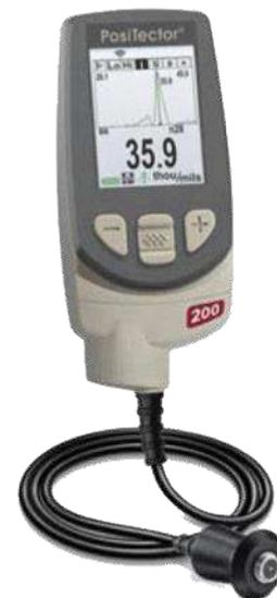
Medidor de espessura não destrutivo em uma ampla gama de aplicações que requerem tecnologia ultrassônica (madeira, concreto, plástico, compósitos, metais, etc.)
