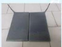
Fotografia delle lastre dopo l'immersione nel liquido di prova "diesel".
