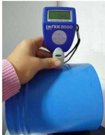
QNix® - Medidores de espessura não destrutivos para revestimentos em substratos ferrosos e não ferrosos
