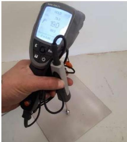
Pirômetro de contato para medição da temperatura de pré-aquecimento; essencial em aço galvanizado, alumínio, aço inoxidável, etc.
